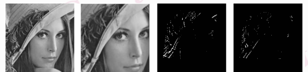
(a) Lena 灰度图像 (b) 近似变换后的图像 (c) 标准算法的帧间差分二值图 (d) 本文算法的帧间差分二值图
